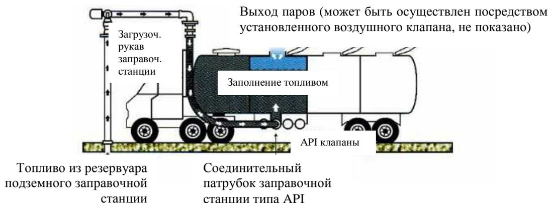
Рис.Г – слив топлива из автоцистерны на станции техобслуживания (БЕЗ УЛАВЛИВАНИЯ ПАРОВ)
